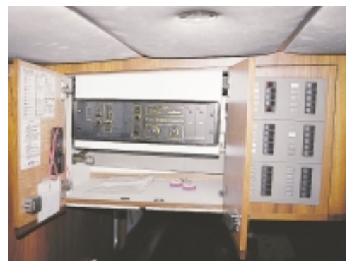
Geballte Technik gleich hinter dem Fahrstand: Das Hauptschaltpaneel für alle technischen Funktionen ermöglicht immer einen schnellen Überblick über die augenblickliche Situation an Bord
