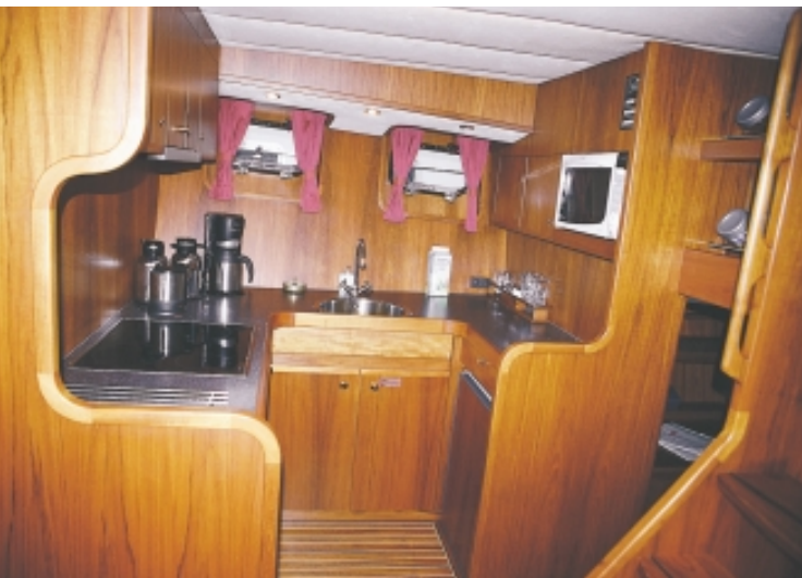
Zweckmäßig eingerichtet, jedoch nicht ganz seefest: Die Arbeitsfläche in der Bordküche sollte zumindest über eine Schlingerreling verfügen
